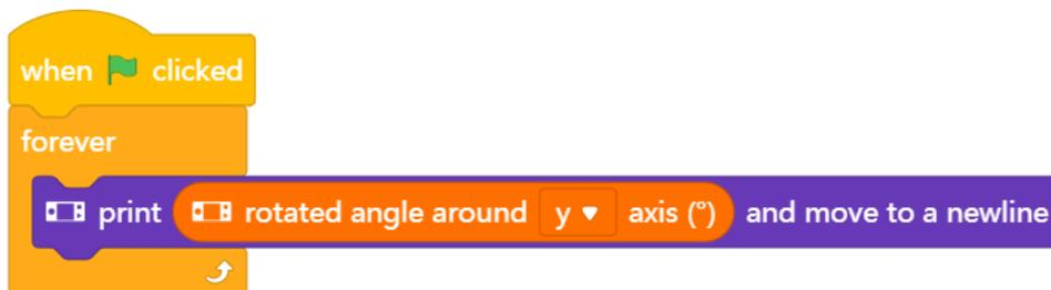
Hay dos aspectos importantes: este bloque hará el seguimiento de los movimientos de rotación superiores a una revolución. Utiliza este bloque para contar cuántas veces ha girado el robot. Mirando el eje Z, una rotación en el sentido de las agujas del reloj aumentará los valores informados por este bloque,
