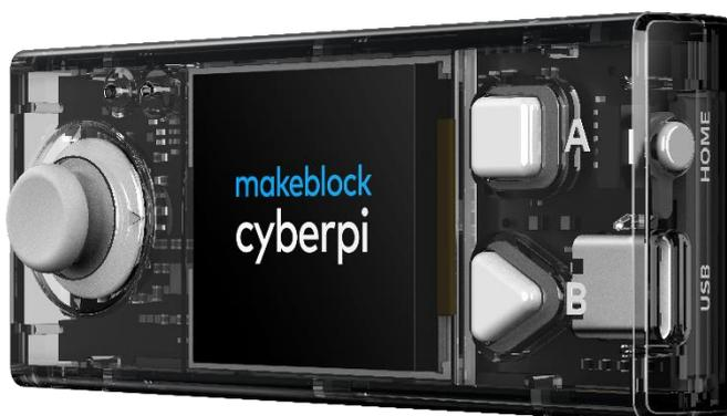
Hay un CyberPi montado en el mBot2. Un CyberPi es un pequeño microordenador programable. Darás órdenes al CyberPi usando los bloques de código de mBlock. El CyberPi devuelve estas órdenes al mBot2. Puedes retirar el CyberPi del mBot2.
